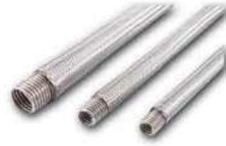
Örgülü esnek metal hortum bağlantıları; endüstriyel esnek bağlantı uygulamalarında buhar, kızgın yağ, su, gaz hatlarında, yüksek basınç ve esneklik gerektiren uygulamalarda kullanılır. Kritik akışkanlarda titreşim ve genişleme almak içinde kullanılmaktadır.
